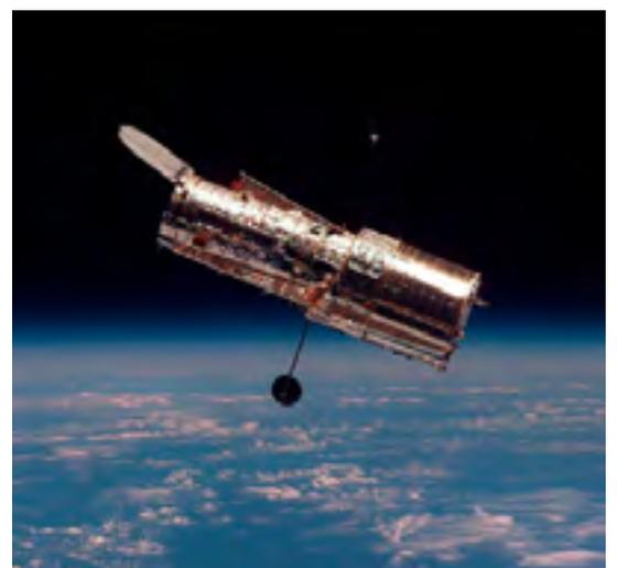
**Le télescope spatial Hubble** tourne à 590 km au-dessus de nos têtes. Cette altitude lui permet d'observer le ciel sans être gêné par l'atmosphère terrestre. Un revêtement fait de 15 couches d'isolant permet aux instruments qu'il utilise de résister aux températures extrêmement froides ou chaudes qu'il traverse.
